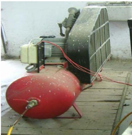
Fig. 8 : Heavy Duty 2-Stage Compressor
