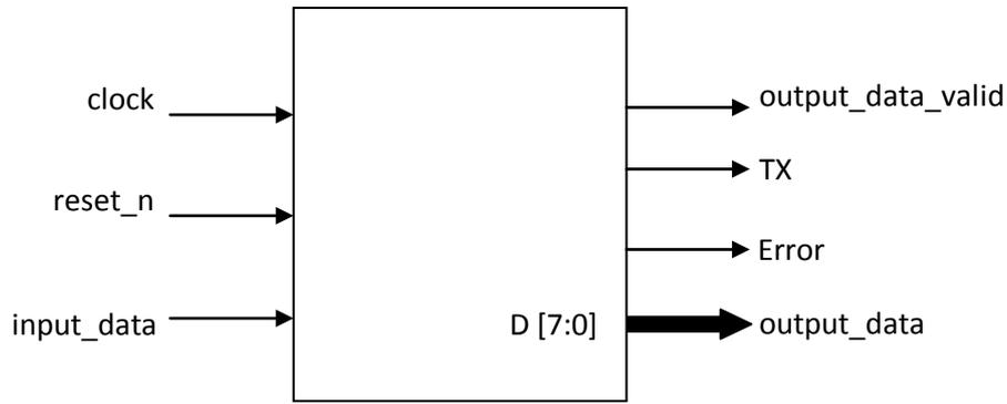
Figure 5 : Digital Compass ASCII RTL Module
