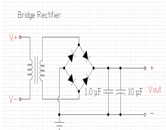
Figure 8 : Bridge rectifier
