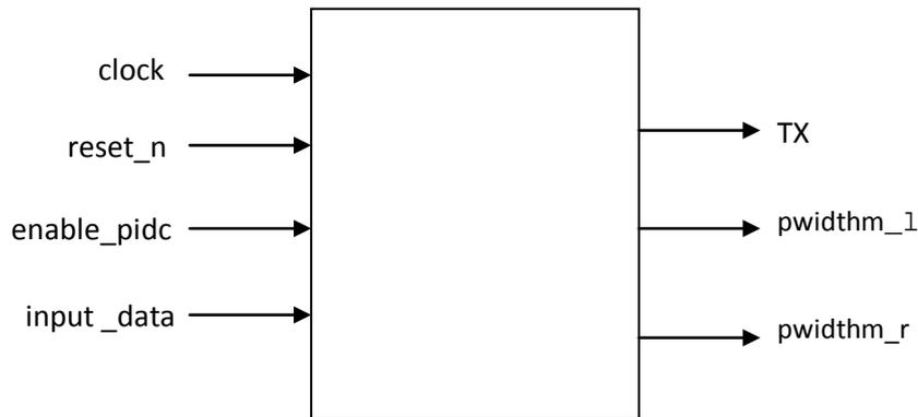
Figure 8 : PID Controller Module
