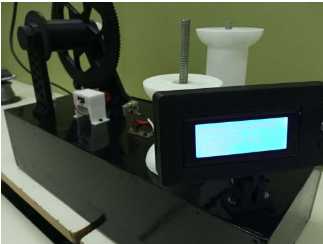
Fig. 12: Montaje de interfaz de usuario, etapa extrusora y etapa colectora de filamento
