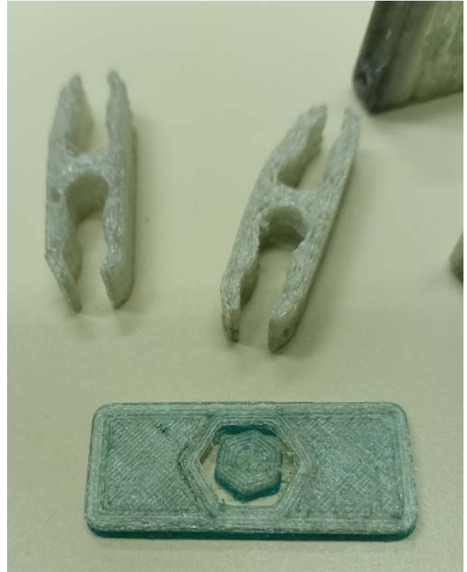
Fig. 13: Muestras de pequeñas piezas impresas con filamento PET reciclado
