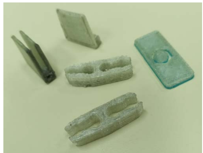
Fig. 14: Muestras de pequeñas piezas impresas con filamento PET reciclado
