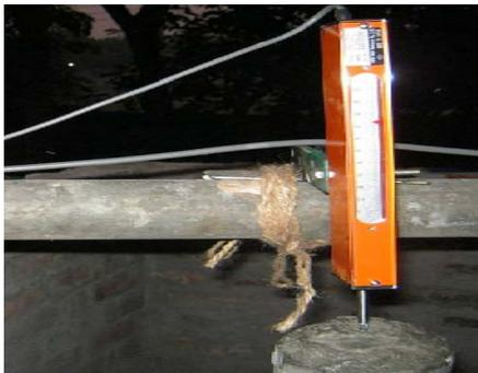
Figure 8 : LVDT Setup
