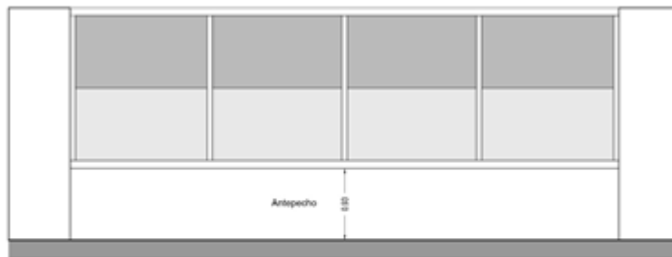
Persianas al 50% de área efectiva ocupada en ventanas - Fachada Sur Sector con antepecho de 93cm
